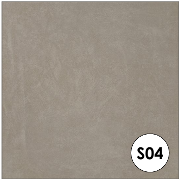
S04 Sol Carrelage Marque Novoceram - Marque française Gamme Tango - Classe 33 - U4P3E3C2 - 600x600mm R9 - Teinte Ciment
